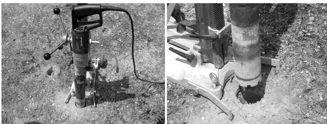
Σχήμα 1: Όψεις δραπάνου και αδαμαντοκορώνας Αριστερά: Δράπανο κατά τη δειγματοληψία, Δεξιά: Οπή δειγματοληψίας
